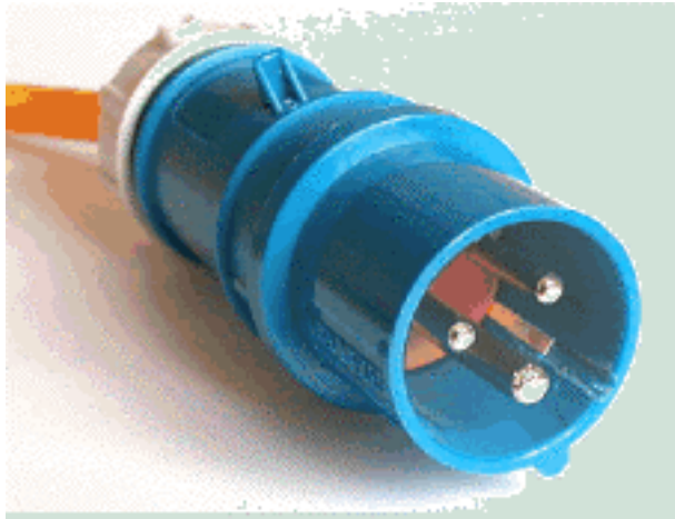
Figuur 26: Aangepaste IEC 60309-2 stekker (Mennekes) voor semi-snellading. Merk de additionele contactstrip in de stekker. Deze laat gewone lading (Mode 1) toe aan 16 A, en semi-snelle lading (Mode 3) aan 32 A.
