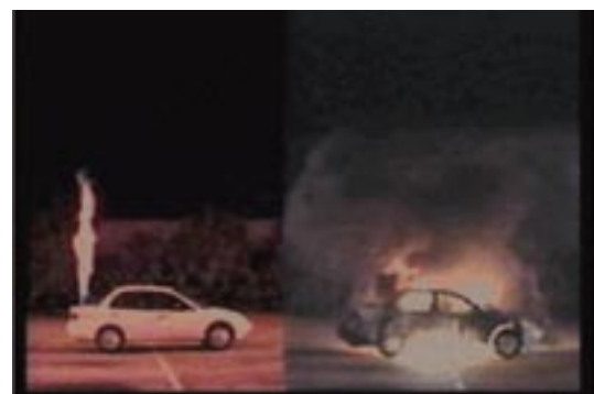
Figuur 15: Vergelijking van een brand met waterstof (wagen links) en benzine (wagen rechts). Foto links: 3 seconden na ontsteking; foto rechts: 60 seconden na ontsteking (Bron: Swain, 2001).
